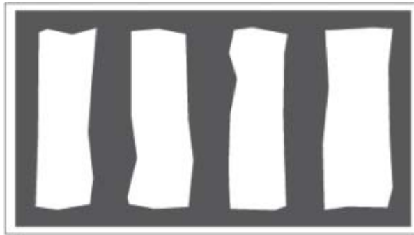
Incollaggio a cordolo perimetrale e strisce
